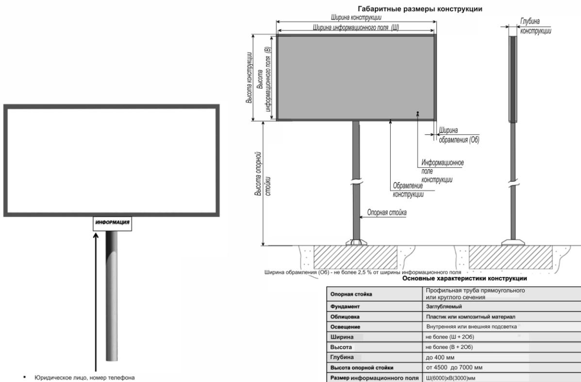
Варианты размещения опорной стойки щита 6 x 3 м
